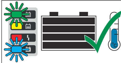
Para uma vida útil ideal da bateria, separar a bateria do sistema de carregamento de baterias de acordo com a declaração a seguir, quando além da indicação verde se acender a indicação azul „Bateria resfriada“. Se forem usados diversos sistemas de carregamento de baterias, primeiro remover a bateria que já foi carregada por completo há mais tempo (a mais resfriada).
