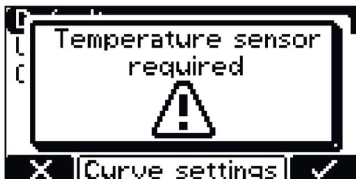
Se for selecionada uma curva sinérgica que necessita de um sensor de temperatura externa, é exibida uma nota.
