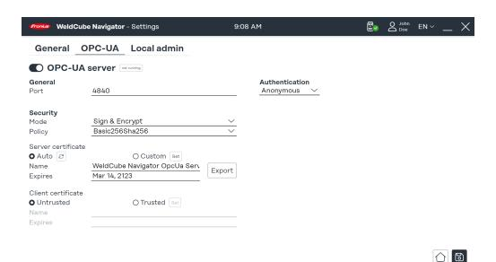
Établir une connexion avec un serveur OPC UA pour permettre à WeldCube Navigator de communiquer avec un système client externe :
