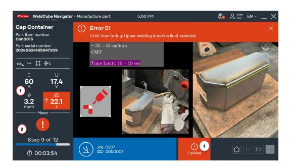
WeldCube Navigator arrête le traitement dès qu'une erreur se produit dans le process de soudage. Si la fonction **Bloquer en cas d'erreur** est activée, l'affichage change en cas d'erreur :
